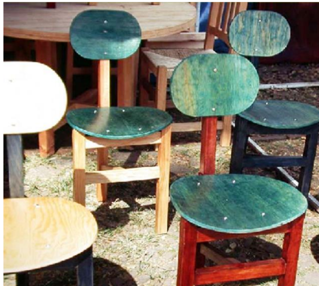
FIGURA 1. Ejemplode Diseño Sustentable: sillas que utilizan 5 veces menos madera (local) que los modelos tradicionales.
