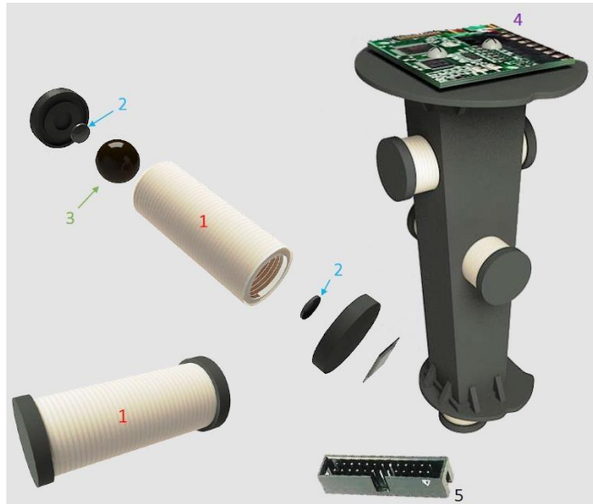
FIGURA 13. Sistema de captación de energías “perdidas” por movimiento mecánico: (1) bobina, (2) cerámica piezoeléctrica, (3) imán de neodimio, (4) placa electrónica, (5) conexión IDC.
