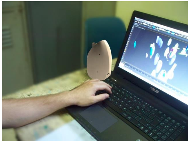
FIGURA 10. Cargador portátil aprovechando el calor desprendido en la salida de disipación de una laptop.
