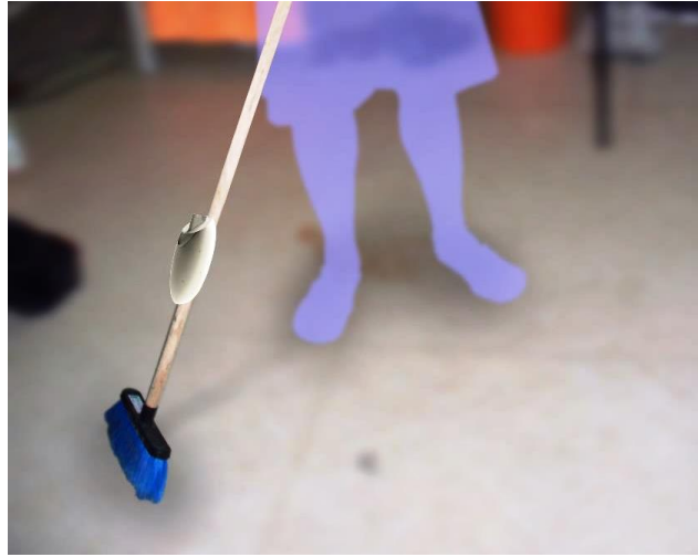
FIGURA 11. Cargador portátil aprovechado el movimiento de la escoba al barrer.
