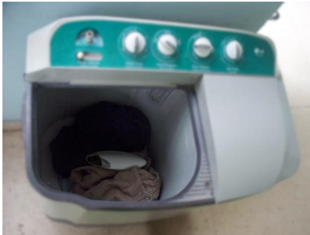
FIGURA 12. Cargador portátil aprovechando el movimiento del agua en la lavadora.
